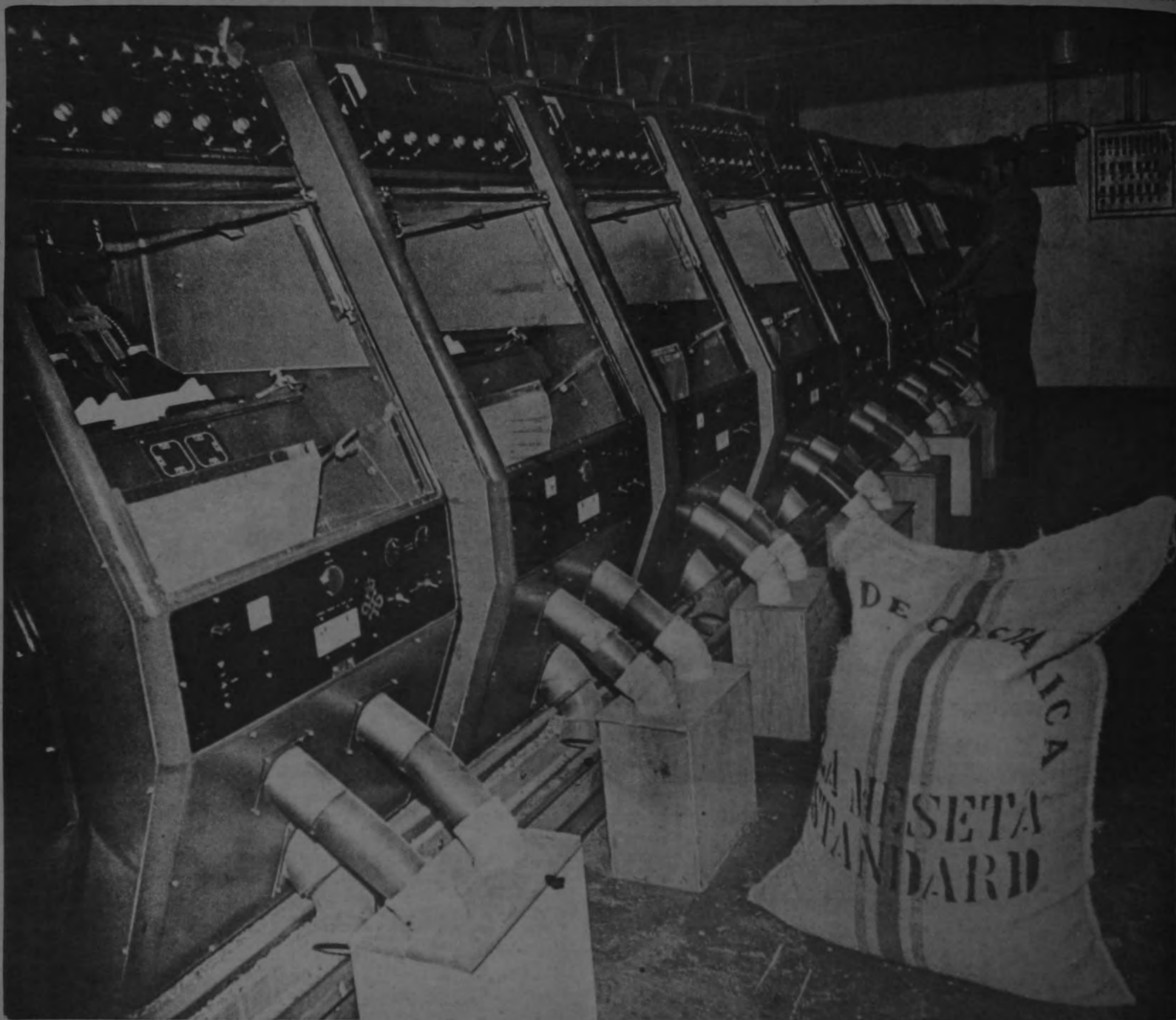
Equipo de las máquinas electrónicas para escoger café en el Beneficio San Pablo de Cafetalera Industrial La Meseta Ltda.
