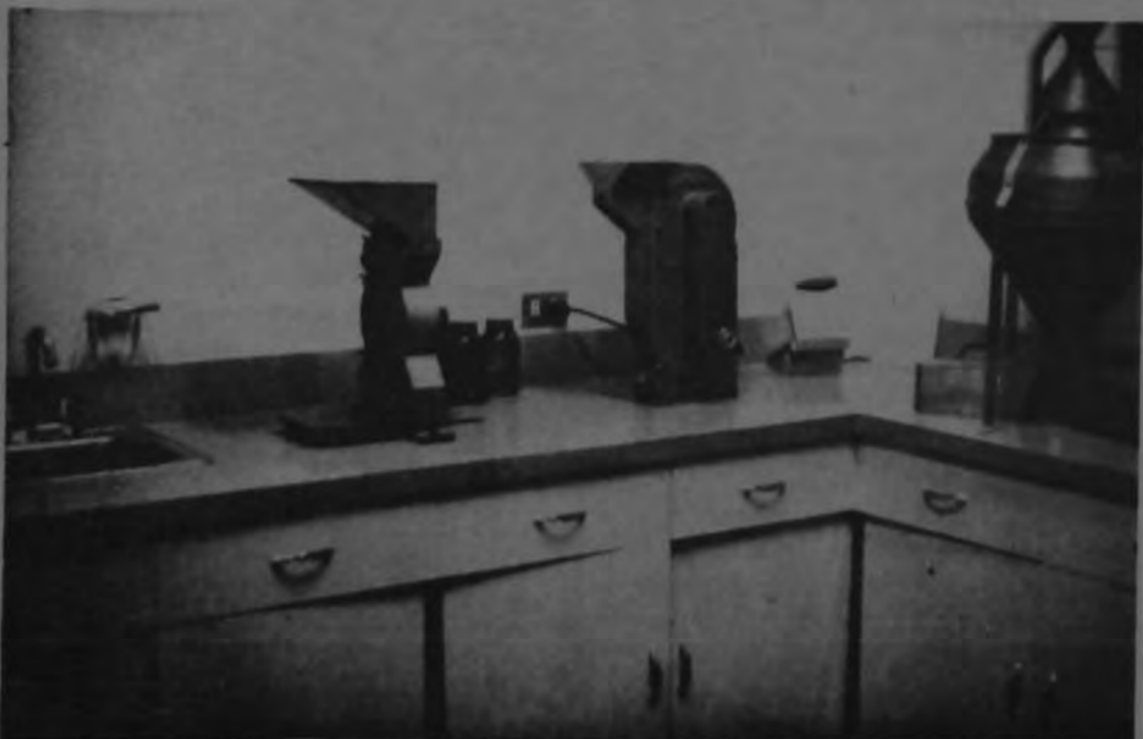
Moderno instrumental adquirió la Oficina de Café para el laboratorio de Barva de Heredia. Esta es una peladora catadora y homogenizadora de muestras.
