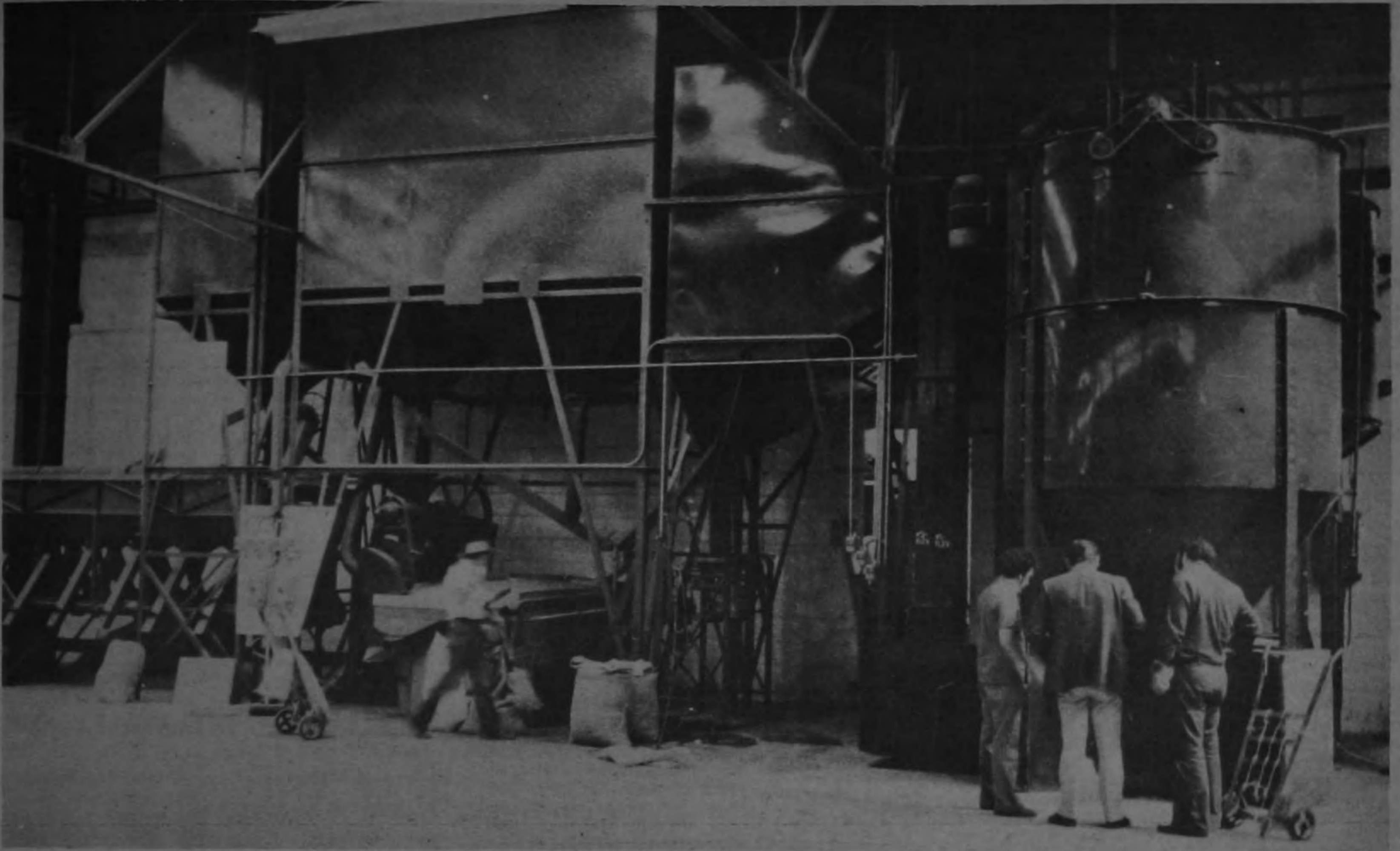
Vista parcial del moderno equipo instalado en La Marta, donde observamos las tolvas que tienen una capacidad total de 600 qq.
